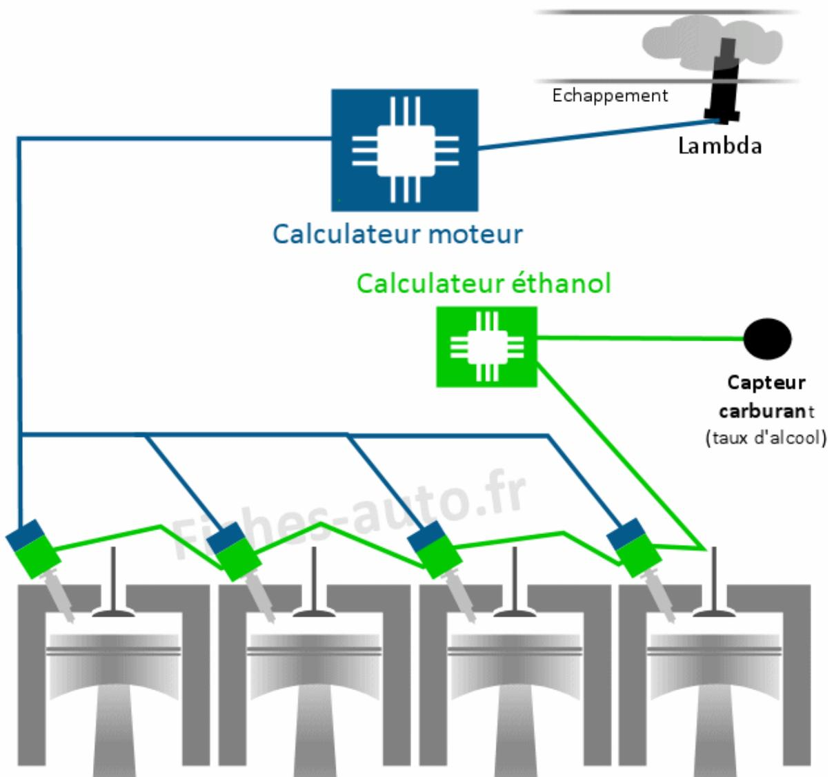
Dans le cas où il y a de l'éthanol, ce dernier va ouvrir plus longtemps les injecteurs, ce qui permettra donc d'arriver au dosage 10/1 de l'éthanol
