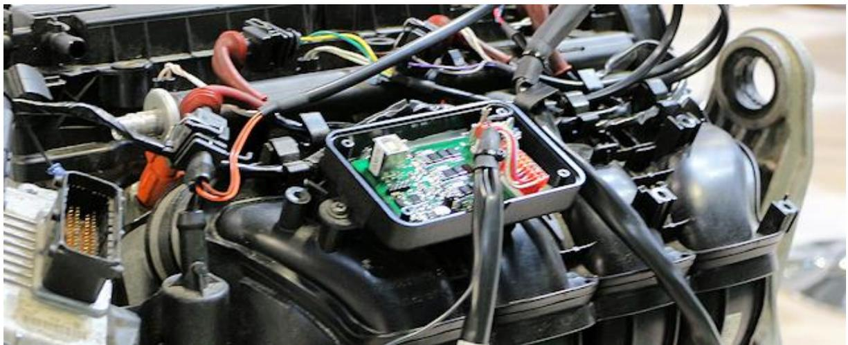
Pour cela on peut alors modifier le pilotage des injecteurs en reprogrammant le calculateur moteur, mais il existe aussi une autre solution avec les boîtiers éthanol, ce qui nous intéresse ici.
